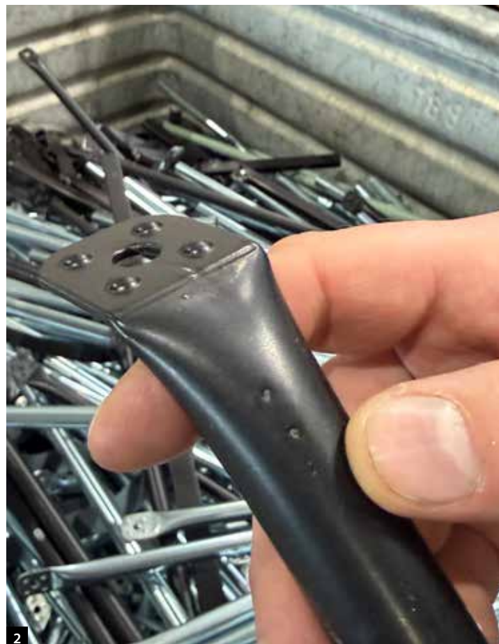
1 Qualitätskontrolle an einen verzinkten Systemrohr mit Abplatzungen
