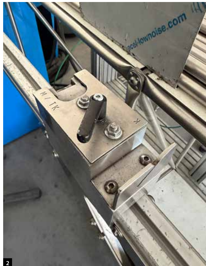
1 Mutterstabpresse mit Werkzeug für kreuzförmige Umformung
