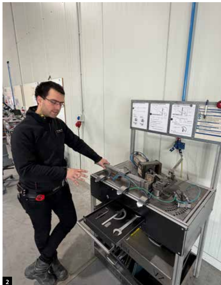
2 Alex erläutert die pneumatische Biegebank, in der die Diagonalen endgefertigt werden.
