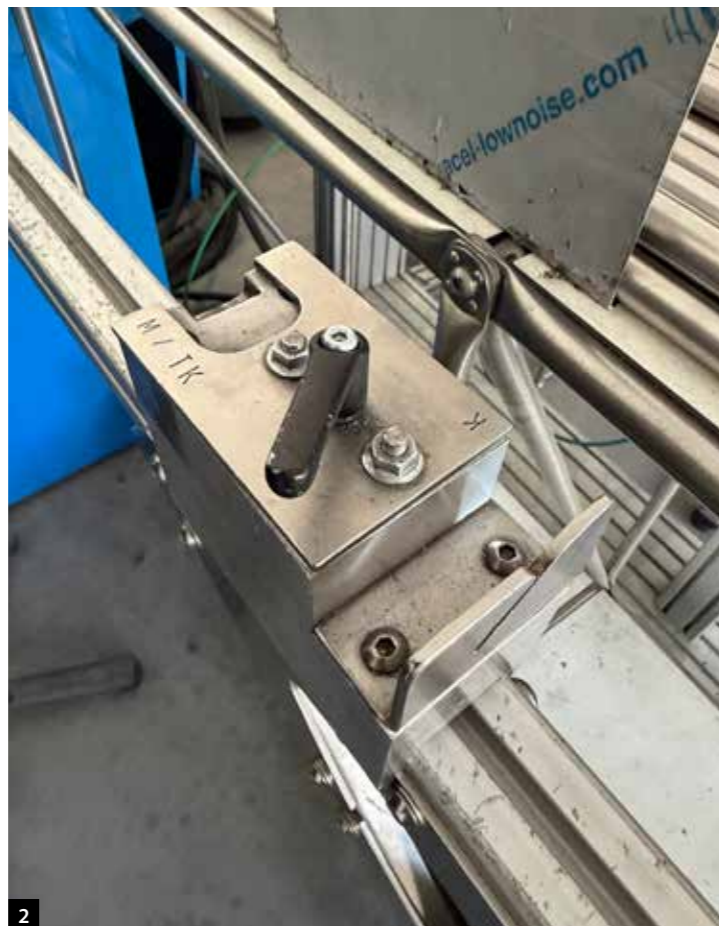
1 Mutterstabpresse mit Werkzeug für kreuzförmige Umformung
