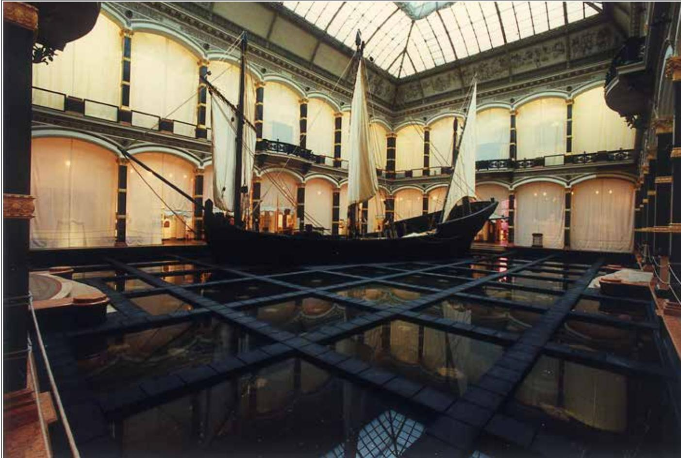
Das Lieblingsschiff des Christoph Kolumbus, die Niña, bestimmte als Wasserlinienmodell den Lichthof des Martin-Gropius-Bau. Ein solches Modell hat zu schwimmen und gleichzeitig ist das Wasser das Symbol der Trennung und der Verbindung zwischen den beiden Kontinenten. Um bei einer Havarie nicht das Ganze Sockelgeschoss in Gefahr zu bringen, wurde die Fläche in einzelne Becken geteilt. Gegen Fäulnis füllten wir die Becken mit Leben, also mit Fischen, Schnecken und Pflanzen.
