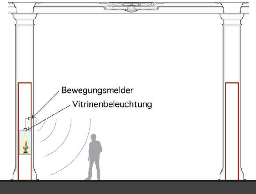
Bewegungsmelder für Lichtsteuerung Funktionsschema
